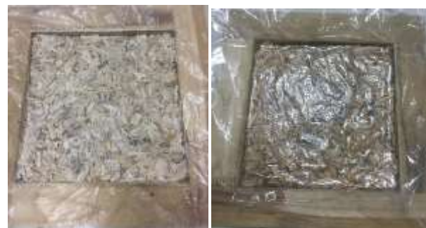
รูปที่ 7. แสดงวิธีการอัดกาบกล้วยเป็นแผ่น ทำเป็นไม้ประดิษฐ์
