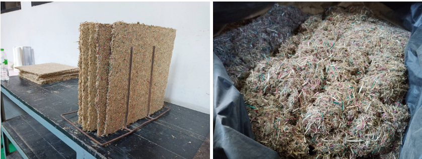
ภาพประกอบที่ 2 แสดงเศษกระจูดที่บดละเอียดแล้วนำมาอัดเป็นแผ่น
