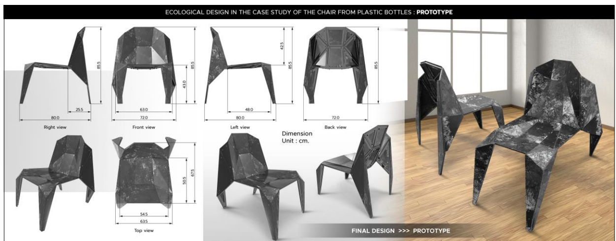
รูปที่ 6 แสดงต้นแบบเก้าอี้จากขวดพลาสติก
