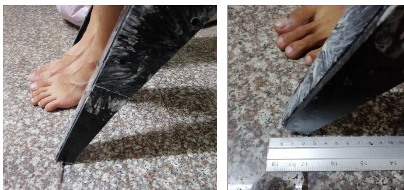
รูปที่ 7 แสดงการทดสอบการรับน้ำหนักของต้นแบบเก้าอี้ โดยวัดระยะการกางออกของขาเก้าอี้
