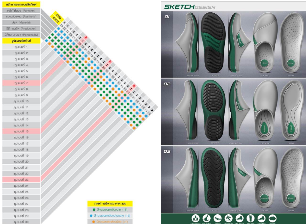
ภาพ 5 (ซ้าย) ตารางการกระจายหน้าที่การวิเคราะห์เชิงการออกแบบผลิตภัณฑ์ (ขวา) Sketch design รูปแบบรองเท้าที่มีค่าคะแนนมากที่สุด 3 รูปแบบ
