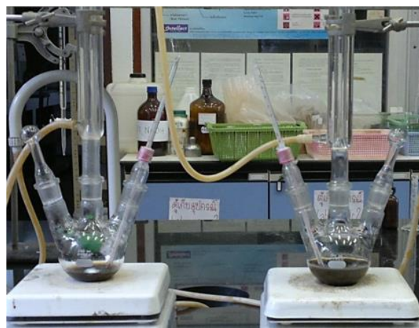
รูปที่ 3 การจัดตั้งเครื่องมือในการทำปฏิกริยาเอสเทอร์ฟิเคชัน
