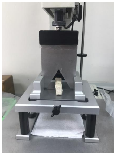
ภาพที่ 3.2 การติดตั้งหัววัดและการวางตัวอย่างสำหรับวิเคราะห์ลักษณะเนื้อสัมผัส
