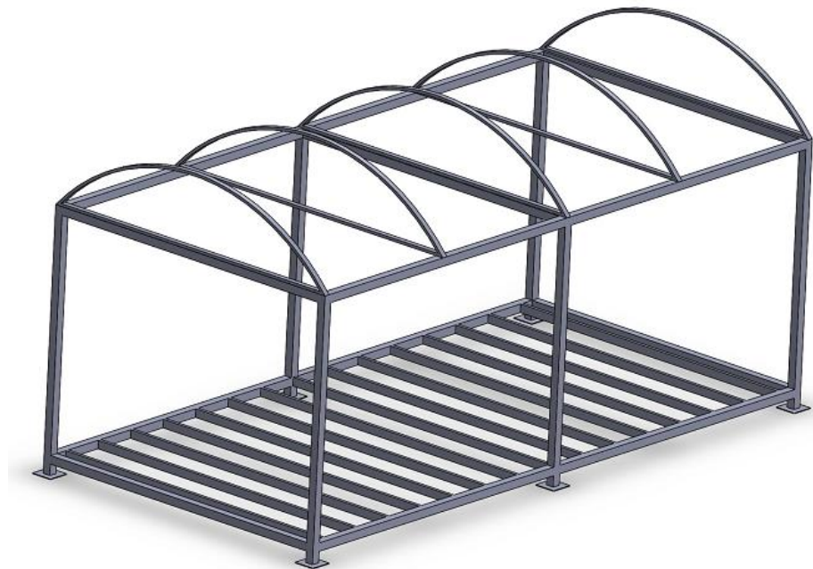
ภาพที่ 3.1 โครงท่อกัลวาไนซ์ของโดมพลังงานแสงอาทิตย์
