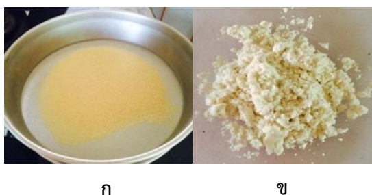
รูปที่ 3 ลักษณะของกระดูกหมู (ก) ก่อนเผา (ข) หลังผ่านการเผาที่อุณหภูมิสูง (PB)
