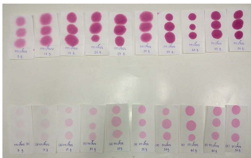
ภาพที่ 6.3 การทดสอบสีม่วงแดงจากกระเจี๊ยบที่สกัดด้วยน้ำและแอลกอฮอล์
