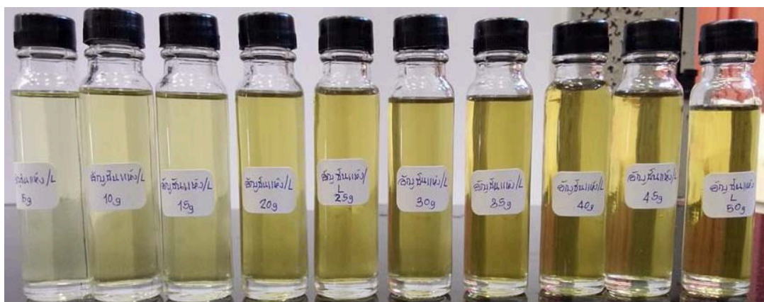
ภาพที่ 6.29 การทดสอบสีน้ำเงินเขียวจากอัญชันแห้งสกัดด้วยแอลกอฮอล์
