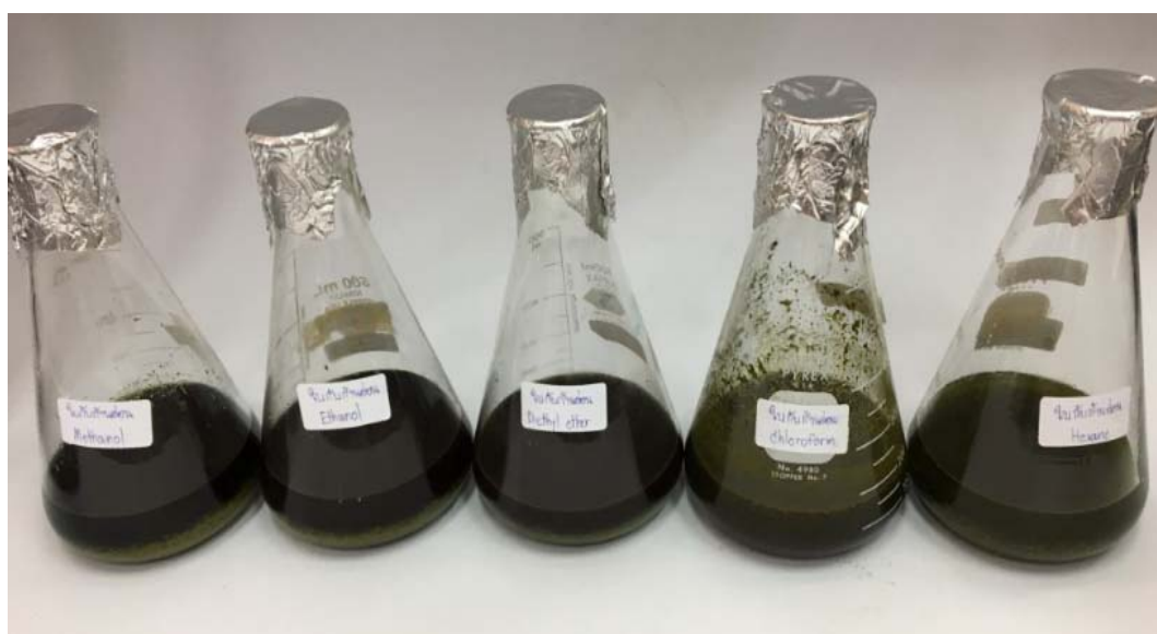
ภาพที่ 6.6 ชั่งใบกับก้านอ่อนที่ปั่นละเอียดบรรจุลงในขวดรูปชมพู่ปริมาณขวดละ 25 กรัมต่อตัวทำละลาย 150 มิลลิลิตร
