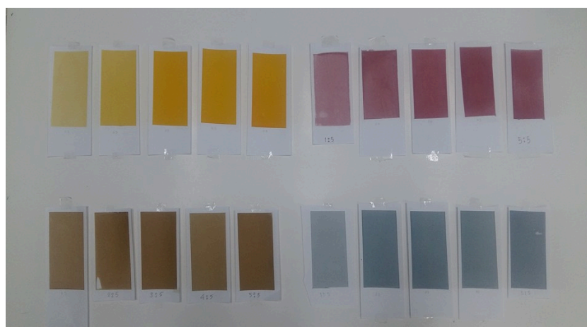
ภาพที่ 6.6 การทดสอบสีของผงสีสีม่วงแดง สีเหลือง สีน้ำเงินเขียว และสีดำ
