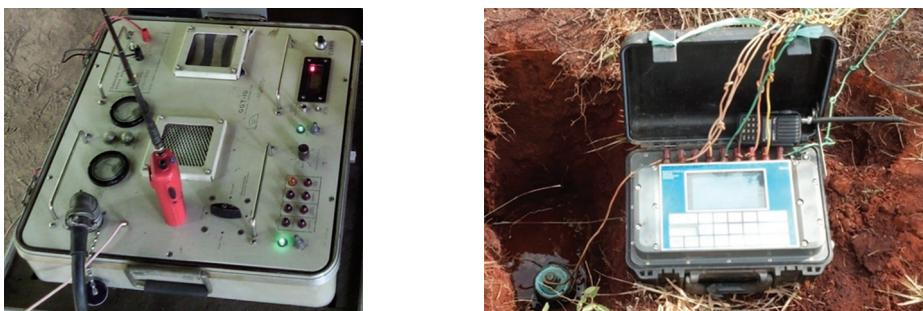
(ก) เครื่องปล่อยกระแสไฟฟ้า Zonge GTT-10 (ข) เครื่องวัดค่าความต้านทานไฟฟ้า Scintrex IPR-12
