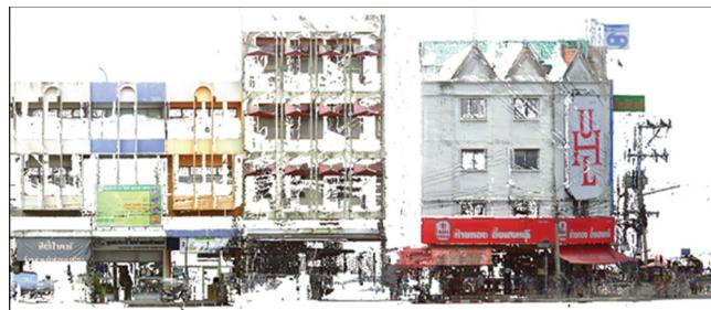
รูปที่ 15 รูปด้านข้างที่ได้จากแบบจำลอง 3 มิติโดยเครื่อง Faro 3D Scanner
