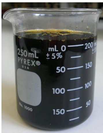
รูปที่ 1 น้ำมันกรดที่ได้จากกระบวนการผลิตน้ำมันถั่วเหลือง
