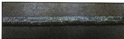
ภาพที่ 4 ตัวอย่างชิ้นงานเหล็กเหนียว (SS400) ที่เชื่อมด้วยลวดเชื่อมไฟฟ้าหุ้มฟลักซ์ ชนิด E 6013 ลวดเชื่อม อบที่อุณหภูมิ 80°C
