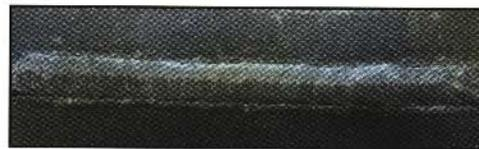
ภาพที่ 3 ตัวอย่างชิ้นงานเหล็กเหนียว (SS400) ที่เชื่อมด้วยลวดเชื่อมไฟฟ้าหุ้มฟลักซ์ ชนิด E 7016 ลวดเชื่อม อบที่อุณหภูมิ 80°C
