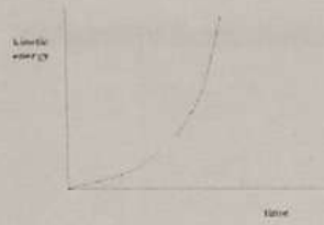
รูปที่ 4 พลังงานจลน์ของวัตถุในการตกสู่ระดับอ้างอิง
