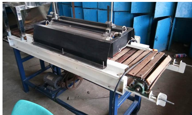
รูปที่ 3 การทำงานของเครื่องกำจัดแมลงในข้าวสารโดยใช้ความร้อนจากรังสีอินฟราเรดต้นแบบ
