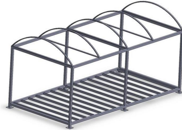
ภาพที่ 6 โครงท่อกัลวาไนซ์ของโดมพลังงานแสงอาทิตย์
