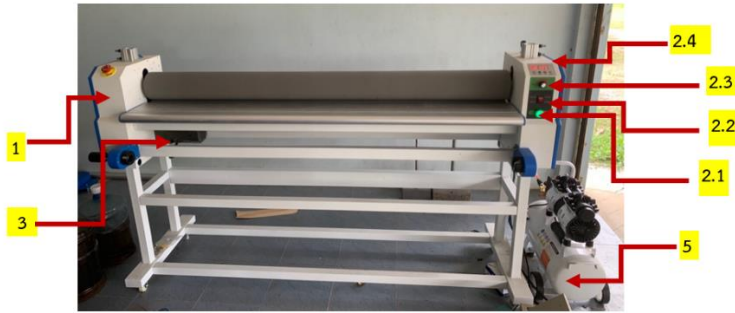
ภาพที่ 11 แสดงลักษณะและส่วนประกอบของเครื่องรีดกากกล้วย
