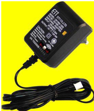
ภาพที่ 4 : ส่วนจ่ายพลังงานไฟฟ้ากับบอร์ดวัดอุณหภูมิและความชื้น
