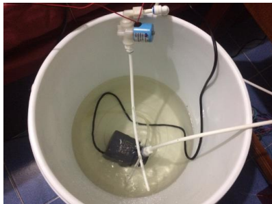
ภาพที่ 10 : การเชื่อมต่อวาล์วโซลินอยด์และปั้มน้ำ
