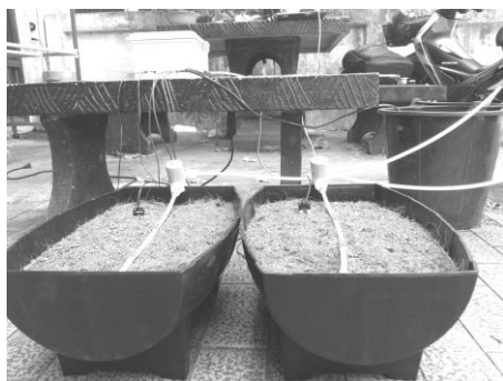
ภาพที่ 6 : การติดตั้งมอดูลวัดความชื้นในดินเพื่อใช้งาน
