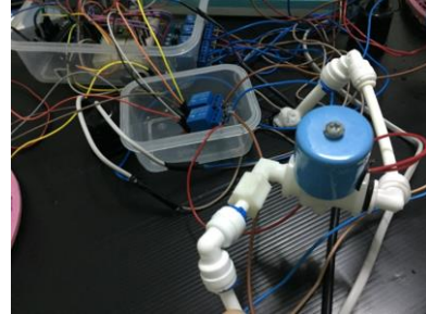
ภาพที่ 21 : การเชื่อมต่อภายในมอดูลให้สารอาหาร
