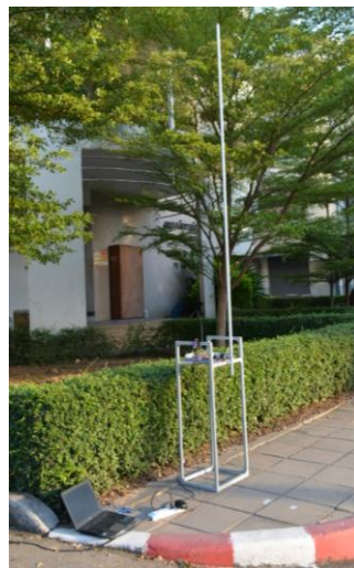
ไม้กั้นเปิด-ปิดทางรถไฟ และ อุปกรณ์ตัวรับรู้ที่ 2 (S2)
