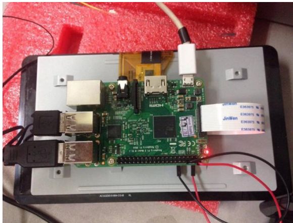
ภาพที่ 6 การเชื่อมต่อระหว่างบอร์ดราสเบอร์รี่พาย กับจอทัชสกรีนผ่าน
