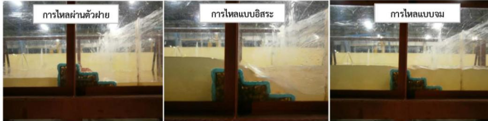
ภาพที่ 4 การไหลของน้ำผ่านฝายทั้งสามกรณี (ที่มา: [กริธาทัพ, 2557])
