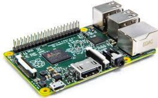
ภาพที่ 2 ภาพแสดงลักษณะบอร์ดบอร์ดราสเบอร์รี่พาย
