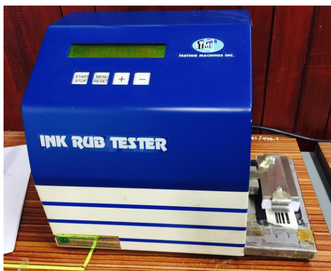
ภาพที่ 3. 22 เครื่อง Ink rub tester ทดสอบการขจัดเพื่อดูการยึดติดของหมึกกับแผ่นชิ้นงาน
