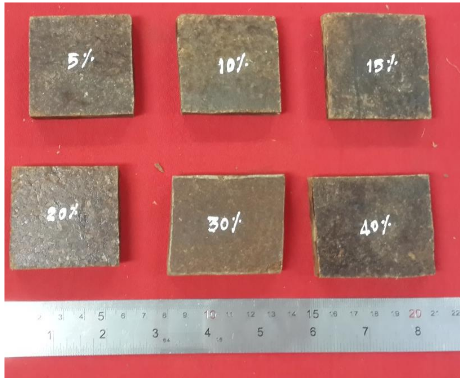
แผ่นชิ้นงานทดสอบค่า Internal bond
