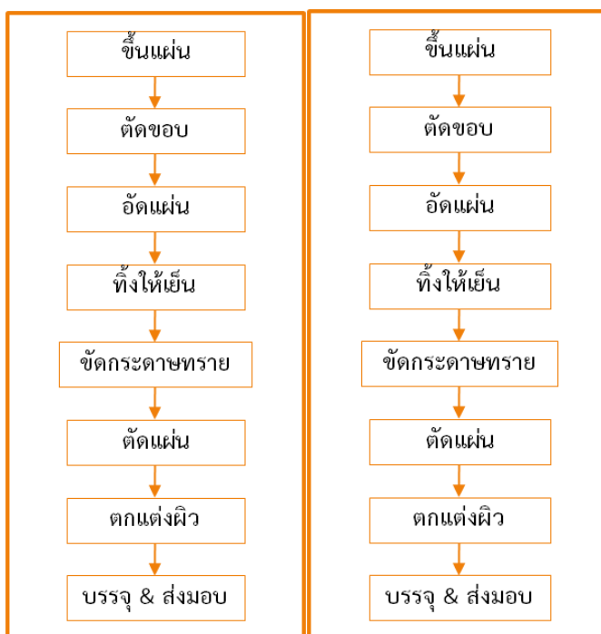
ภาพที่ 2. 14 แสดงภาพเปรียบเทียบขั้นตอนการผลิตแผ่นขึ้นไม้อัดและแผ่นใยไม้อัด [1]
