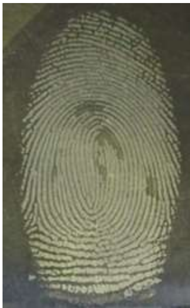
ภาพถ่ายรอยลายนิ้วมือที่ปรากฏหลังจากการชุบโลหะด้วยไฟฟ้าโดยใช้เครื่องที่พัฒนาขึ้น
