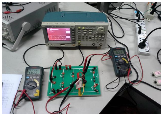
รูปที่ 4.3 แสดงการต่อตัวเก็บประจุไฟฟ้ากับแผงวงจรเพื่อวัดค่ากระแสไฟฟ้าและความต่างศักย์
