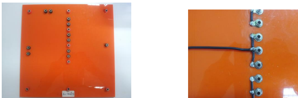
รูปที่ 1.1 แสดงแผงทดลอง ไฟฟ้ากระแสสลับ (ซ้าย) และ แสดงจุดเชื่อมต่อของสายไฟใต้แผงวงจร (ขวา)
