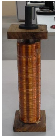
รูปที่ 3.4 แสดงขดลวดเหนี่ยวนำ ปรับค่าความเหนี่ยวนำด้วยแท่งแกรไฟต์
